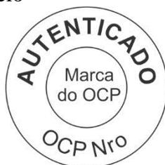
Nota: Diâmetro externo =  $30 \pm 1$  mm e diâmetro interno =  $15 \pm 1$  mm.
